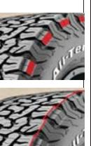
**Особлива конструкція шини дозволяє рухатися при дуже низькому тиску\***
